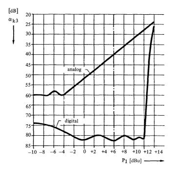
Der Klirrpegel bei der Aufzeichnung von Signalen verhält sich bei digitaler Aufzeichnung ganz anders als bei analoger Aufzeichnung. Beim analogen Tonband steigt der Klirrpegel relativ langsam an, während bei der digitalen Aufzeichnung eine langsame Abnahme bis zur Aussteuerungsgrenze und dann ein sprunghafter Anstieg erfolgt.
