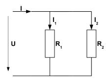
$$\begin{split} U &= konstant \\ I_{ges} &= I_1 + I_2 \\ \frac{1}{R_{ges}} &= \frac{1}{R_1} + \frac{1}{R_2} \\ U &= R_{ges} \cdot I_{ges} = R_1 \cdot I_1 = R_2 \cdot I_2 \end{split}$$
