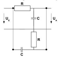
Für eine Bandsperre werden ein Hochpass- und ein Tiefpass-Filter zueinander parallel geschaltet. Der Hochpass bestimmt die obere und der Tiefpass die untere Grenzfrequenz.
